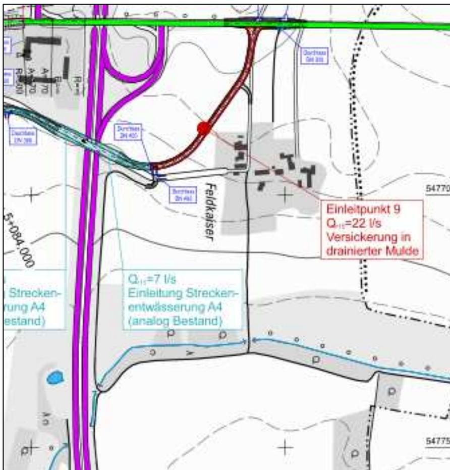
Abbildung 10: Entwässerungsabschnitt EA 9 (Ausschnitt aus Übersichtslageplan Entwässerung, Unterlage 8)
