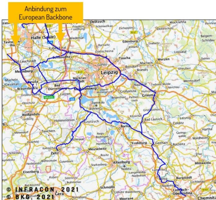
Abbildung 6: Konzept für ein zentrales deutsches Wasserstoffnetz, wie es in der Studie von DBI Gas- und Umwelttechnik GmbH und INFRACON entwickelt wurde
