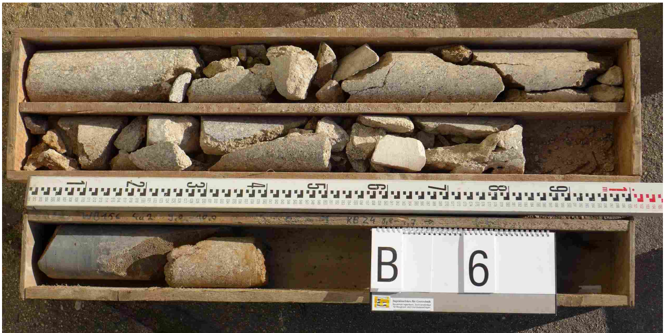
Bild 11: B6 (D2) - Widerlager Maltitz (Südseite), horizontal, Endteufe: 207 cm
