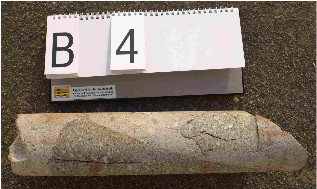
Bild 9: B4 (Widerlager, horizontal), Kernprobe zur Bestimmung der Mörteldruckfestigkeit
