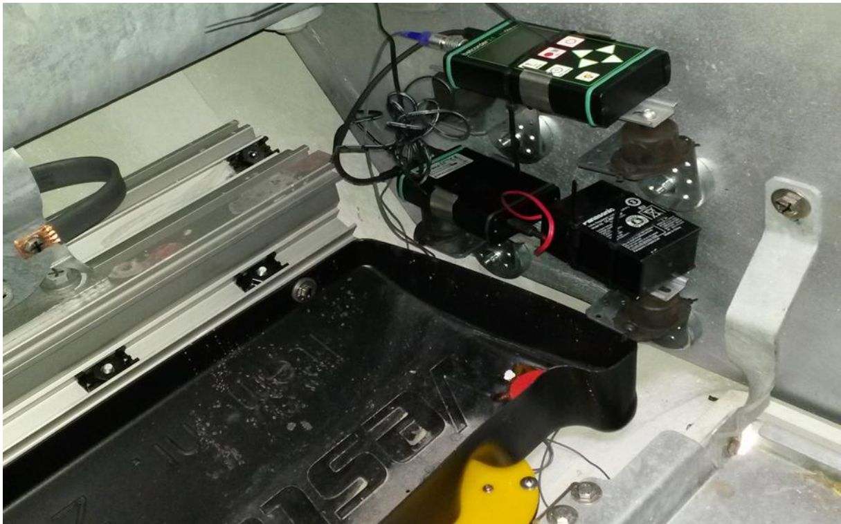
Abbildung 2: beispielhaft: ein batcorder 3.1 inkl. WKA-Erweiterung in der Bodenwanne einer V 126
