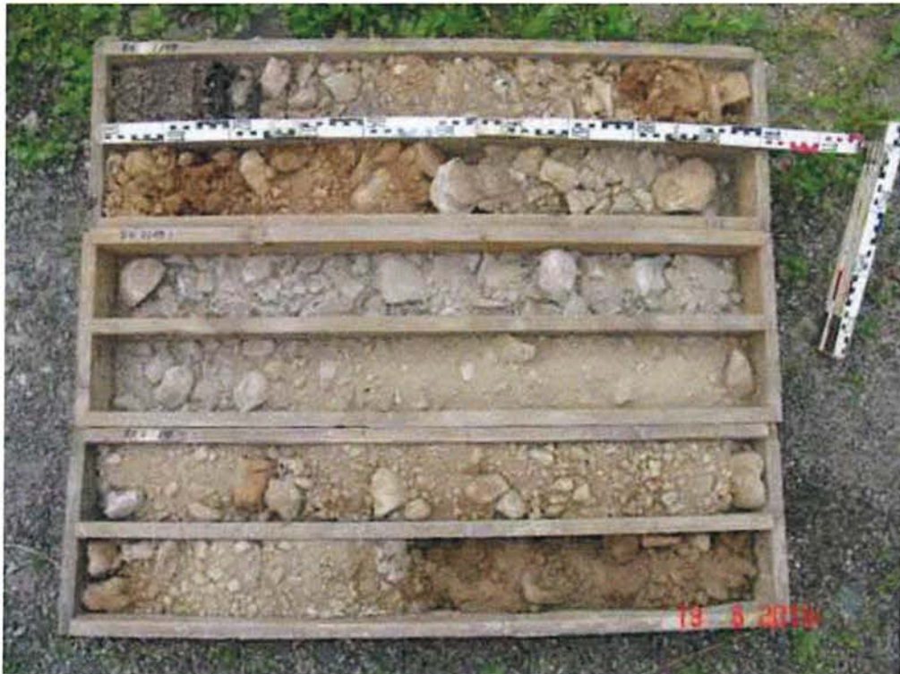
BK 2/19, ausgelegt von 0,00 m (oben links) bis 6,00 m (unten rechts)
