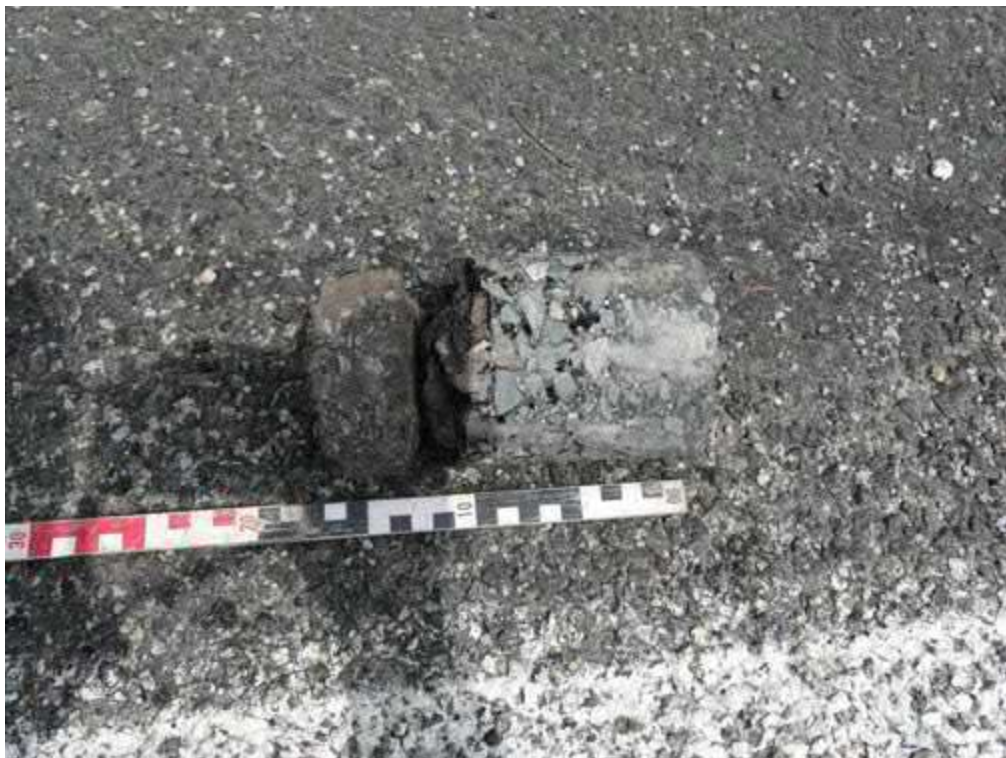
KB 2/19, vor Niederbringen des HS 2/19 aus der gebundenen Tragschicht gebohrt
