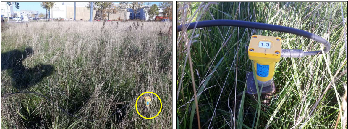
Abb. 4 Messaufnehmer in 24 m Abstand zum nächstgelegenen Gleis (MP 3z Boden)
