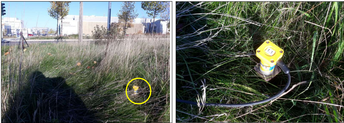
Abb. 2 Messaufnehmer 8 m Abstand zum nächstgelegenen Gleis (MP 1z Boden)
