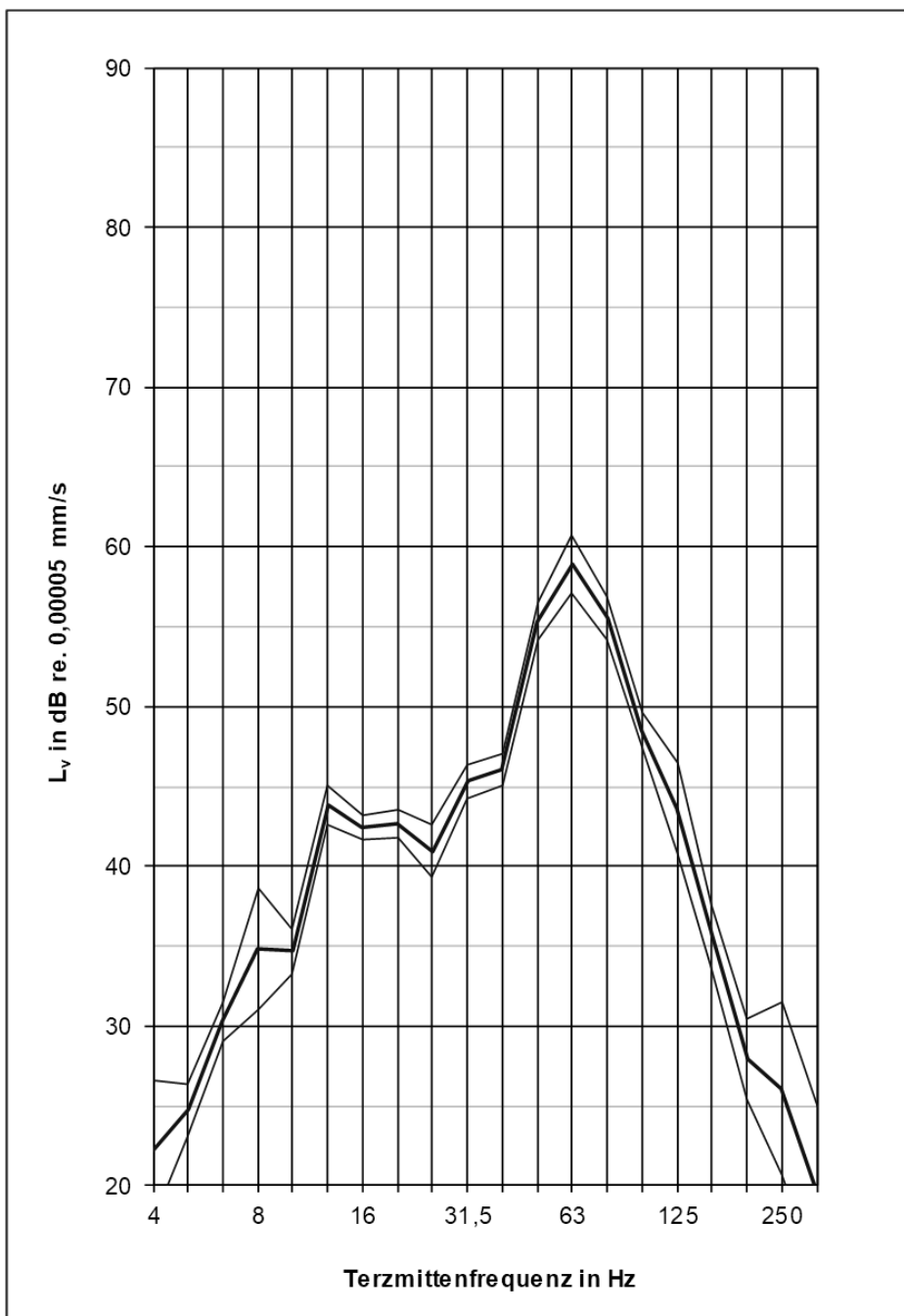
Darstellung: energetischer Mittelwert der Maximalspektren mit Streubereich (Standardabweichung)
