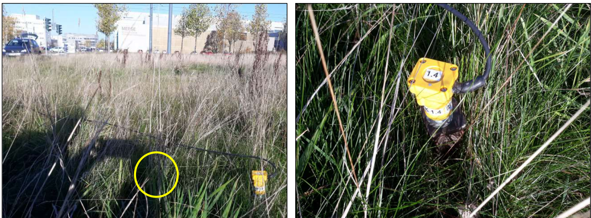
Abb. 5 Messaufnehmer in 32 m Abstand zum nächstgelegenen Gleis (MP 4z Boden)
