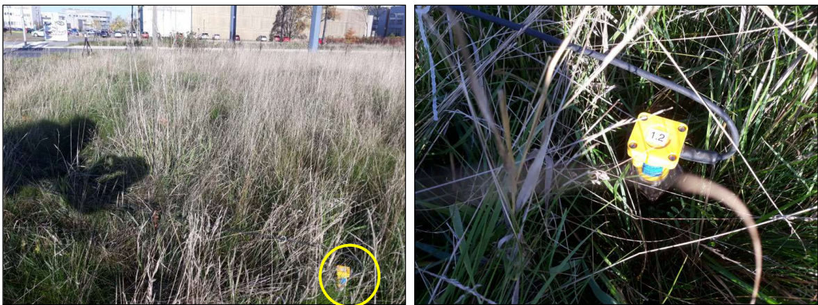
Abb. 3 Messaufnehmer in 16 m Abstand zum nächstgelegenen Gleis (MP 2z Boden)
