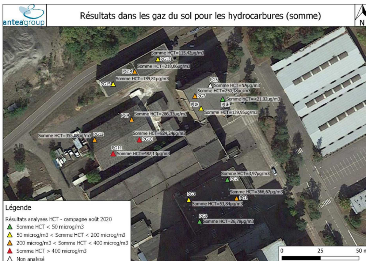
Figure 4 : Résultats des investigations sur l'air du sol en 2020 (source : Rapport ANTEA n°A106703 version A)
