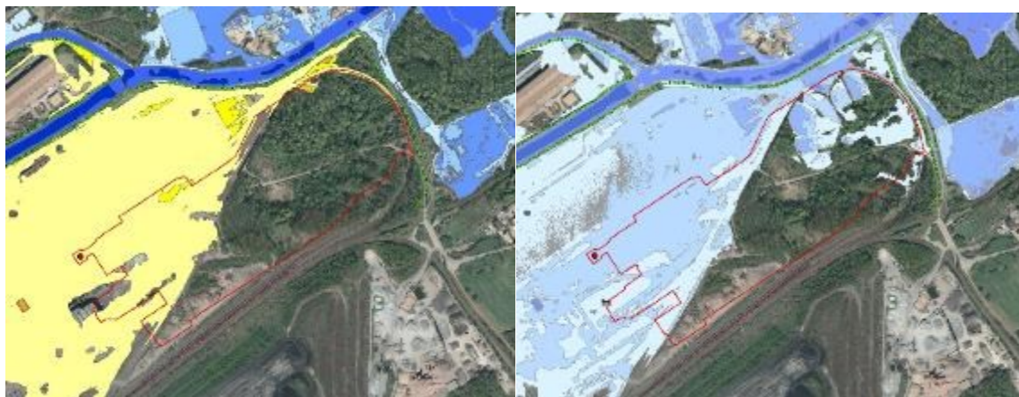
Abbildung 15 links HQ 100 generalisiert; blau Hochwassergefahr, gelb geschützter Bereich; rechts HQ Extrem_generalisiert [23] Vorhabengebiet der EAF und DRI-Anlage (roter Umriss); unmaßstäblich
