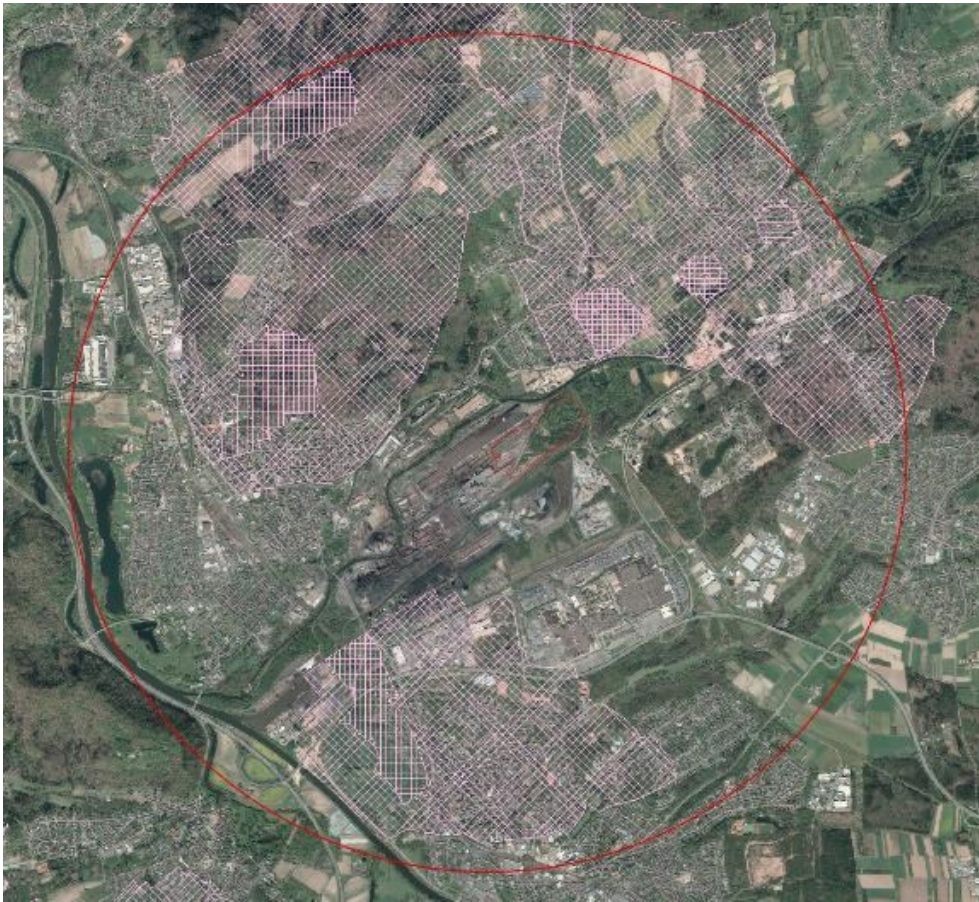
Abbildung 13 Geplante Wasserschutzgebiete (rosa kariert) im 3.750 m-Radius (roter Kreis) um den Emissionsschwerpunkt (roter Punkt) sowie das Vorhabengebiet der EAF und DRI-Anlagen (roter Umriss), [23]
