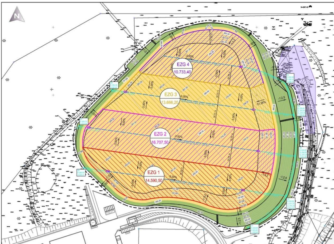
Abbildung 6: Einzugsgebiete der Sickerwasserleitungen
