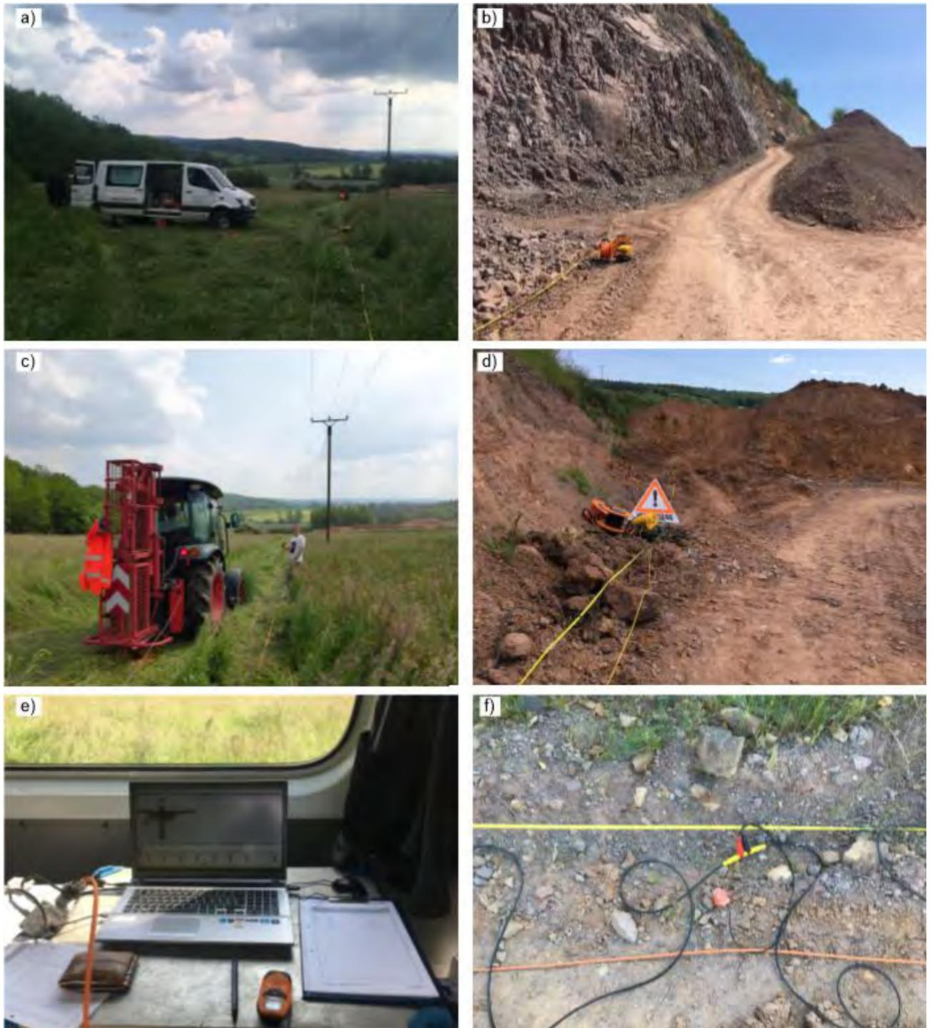
Abbildung 3: a) Profil 3, Wiese zwischen Wald und Steinbruch, Blickrichtung SW, b) Profil 4 im Steinbruch, Blickrichtung SSE, c) seismische Quelle: Fallgewicht am Traktor, d) Geoden und Kabeltrommeln, e) Aufzeichnungs-PC, f) Geophon
