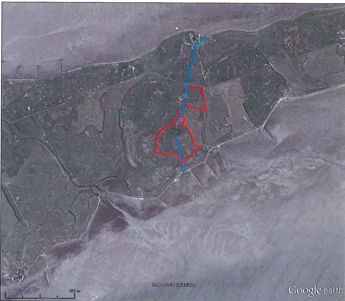
Abbildung 1: Vorhabenflächen inkl. Baustelleneinrichtung und temporärem Kleilager (rote Linien) und Lage der Spülleitungen (blau) (Luftbild aus Google-Earth™ Datenbasis Image © 2018 DigitalGlobe).
