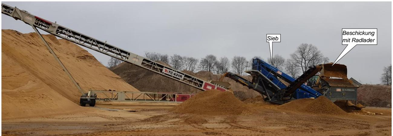
Abbildung 35: Mobil Trockensiebanlage der Firmen Krebs/Brockmann während der Schallpegelmessung am 21.01.2020
