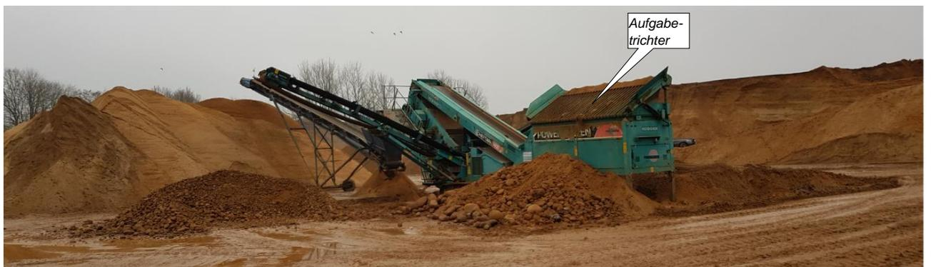
Abbildung 30: Mobile Trockensiebanlage der Firma Rolf Sievers während der Schallpegelmessung am 12.12.2019
