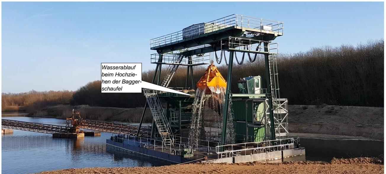
Abbildung 5: Schwimmbagger (Q01) der Firma Ernst Krebs im Einsatz am 19.12.2019
