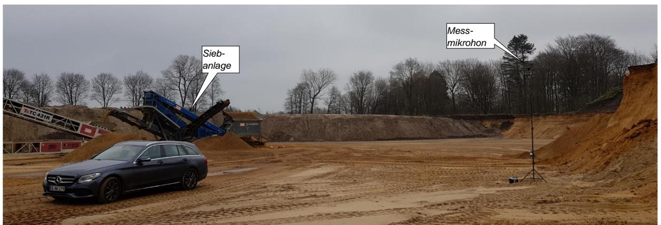
Abbildung 36: Anordnung des Mikrophons während der Schallpegelmessung am 21.01.2020 bei Betrieb der mobil Trockensiebanlage der Firmen Krebs/Brockmann
