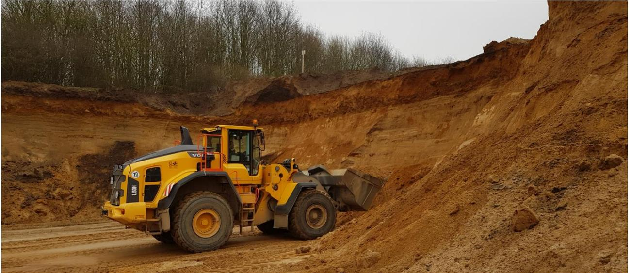
Abbildung 20: Radlader beim Aufnehmen des Bodens aus der Abbaukante in der Abbaufäche der Firma Rudolf Fock
