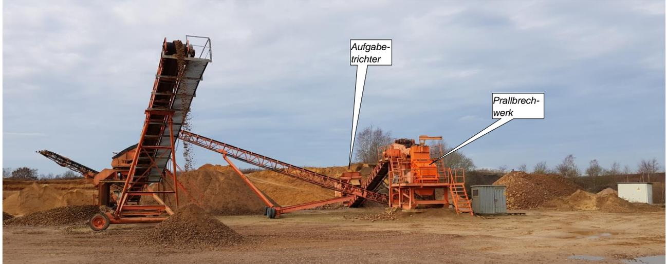
Abbildung 14: Mobile Prallbrechanlage der Firma Ernst Krebs während der Schallpegelmessung am 17.12.2019 (Datei: LOG1989)
