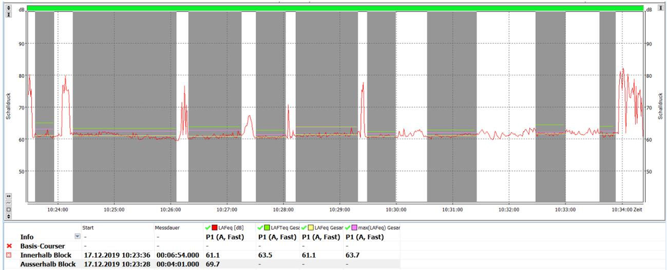
Abbildung 9: Pegelzeitverlauf des Schalldruckpegels beim Betrieb der stationären Nasssiebanlage der Firma Ernst Krebs in 90 m Abstand/stirnseitig (Datei: LOG 1987)
