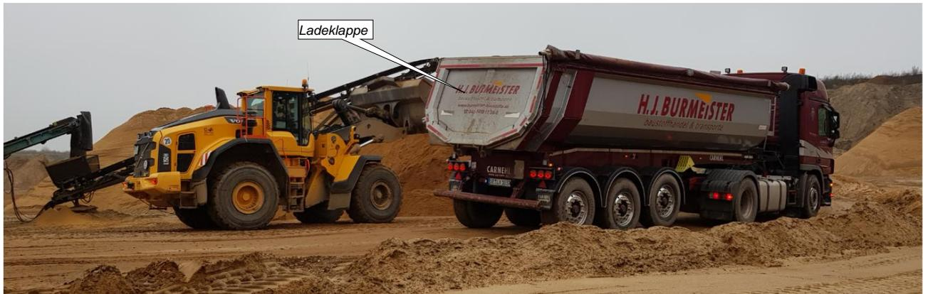
Abbildung 21: Radlader beim Beladen eines Lkw in der Abbaufäche in der Abbaufäche der Firma Rudolf Fock
