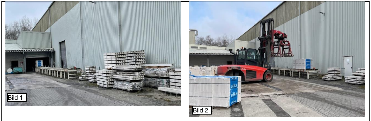
Abbildung 14: Transportband für die Steinpakete nach außen ( Bild 1 ) und Aufnahme der Steinpakete mit dem Gabelstapler ( Bild 2 )
