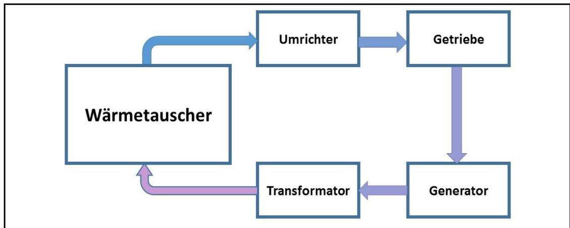
Abb. 3: Schema der Kühlung Großkomponenten im Maschinenhaus
