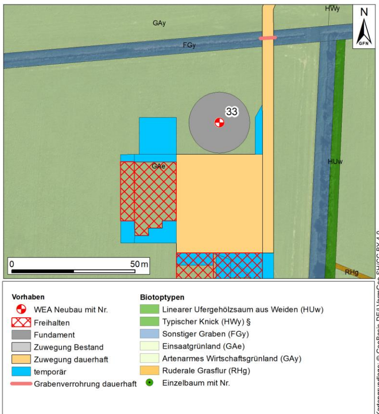
Abb. 7: Maßnahmen (6 m dauerhafte Grabenverrohrung) bei WEA 33
