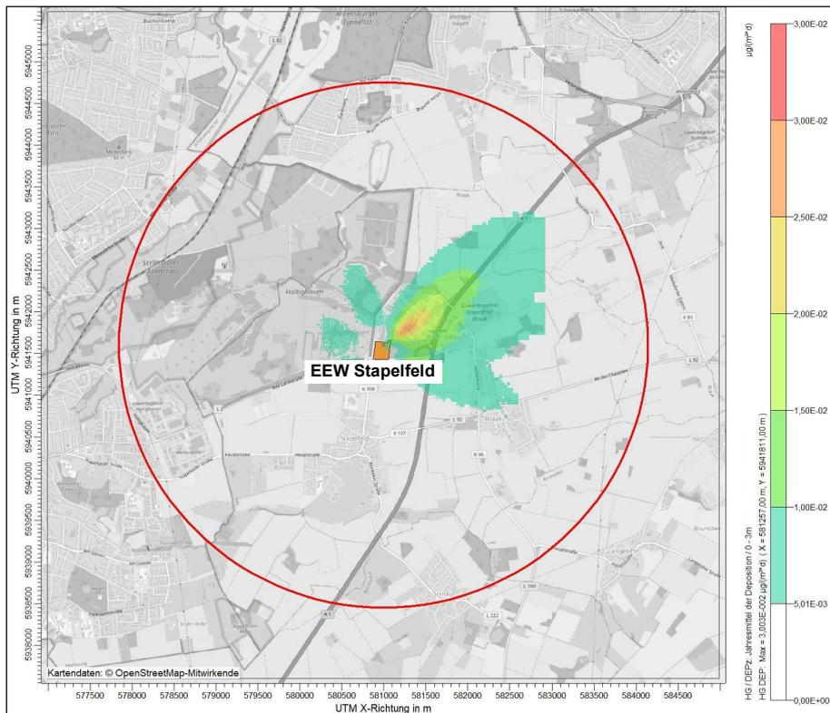
**Abbildung 50.** Räumliche Verteilung der Immissionszusatzbelastung (Jahresmittelwert) für Quecksilber Hg (Deposition) in  $\mu\text{g}/(\text{m}^2 \cdot \text{d})$  durch die Anlage KVA (Prognose 2020)
