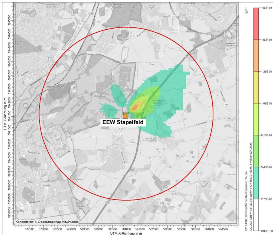
**Abbildung 47.** Räumliche Verteilung der Immissionszusatzbelastung (Jahresmittelwert) für Cadmium Cd (Konzentration) in  $\mu\text{g}/\text{m}^3$  durch die Anlage KVA (Prognose 2020)
