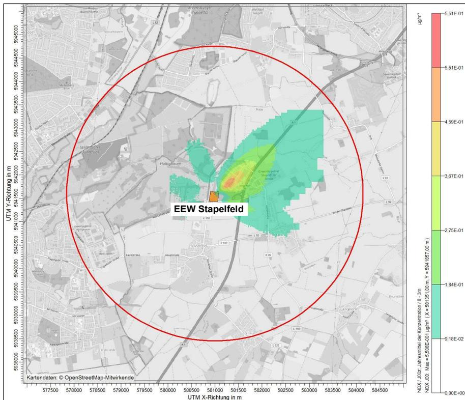
**Abbildung 46.** Räumliche Verteilung der Immissionszusatzbelastung (Jahresmittelwert) für Stickstoffoxide NO<sub>x</sub> in µg/m<sup>3</sup> durch die Anlage KVA (Prognose 2020)
