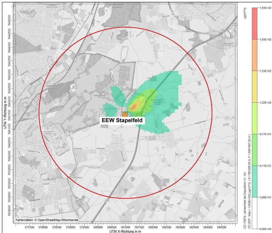
**Abbildung 48.** Räumliche Verteilung der Immissionszusatzbelastung (Jahresmittelwert) für Cadmium Cd (Deposition) in  $\mu\text{g}/(\text{m}^2 \cdot \text{d})$  durch die Anlage KVA (Prognose 2020)
