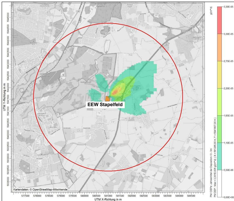
**Abbildung 49.** Räumliche Verteilung der Immissionszusatzbelastung (Jahresmittelwert) für Staubniederschlag in  $g/(m^2 \cdot d)$  durch die Anlage KVA (Prognose 2020)
