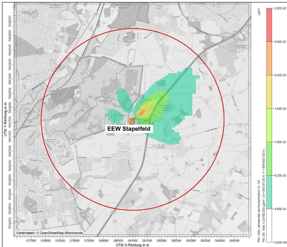
**Abbildung 44.** Räumliche Verteilung der Immissionszusatzbelastung (Jahresmittelwert) für Schwebstaub PM<sub>10</sub> in µg/m<sup>3</sup> durch die Anlage KVA (Prognose 2020)
