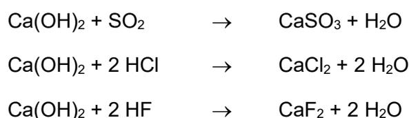
Zur Verbesserung der Abscheideleistung kann das Abgas durch Einbringen von geringen Wassermengen befeuchtet (quenchen) werden. Das Wasser verdampft im heißen Abgasstrom und wird mit diesem als Abgasfeuchte über den Schornstein abgeleitet, ein Abwasseranfall der Abgasreinigung ist somit ausgeschlossen.
