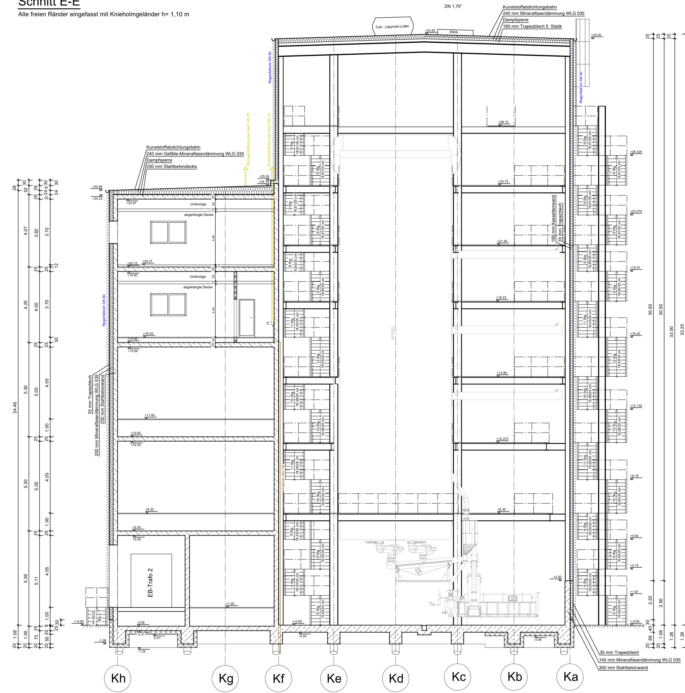
Schnitt E-E Alle freien Ränder eingefasst mit Knieholmgeländer h= 1,10 m
