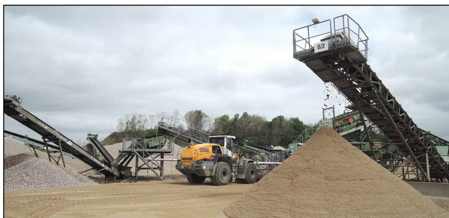
Abbildung 19: Aufbereitungsanlage aus dem KW Schalkholz
