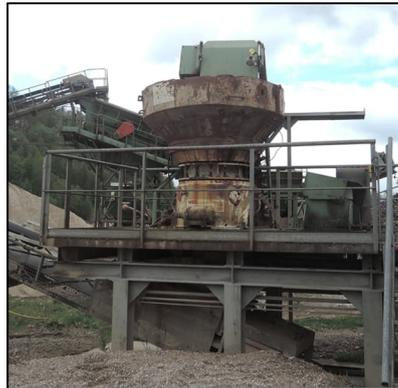
Abbildung 20: Kegelbrecher aus dem KW Schalkholz
