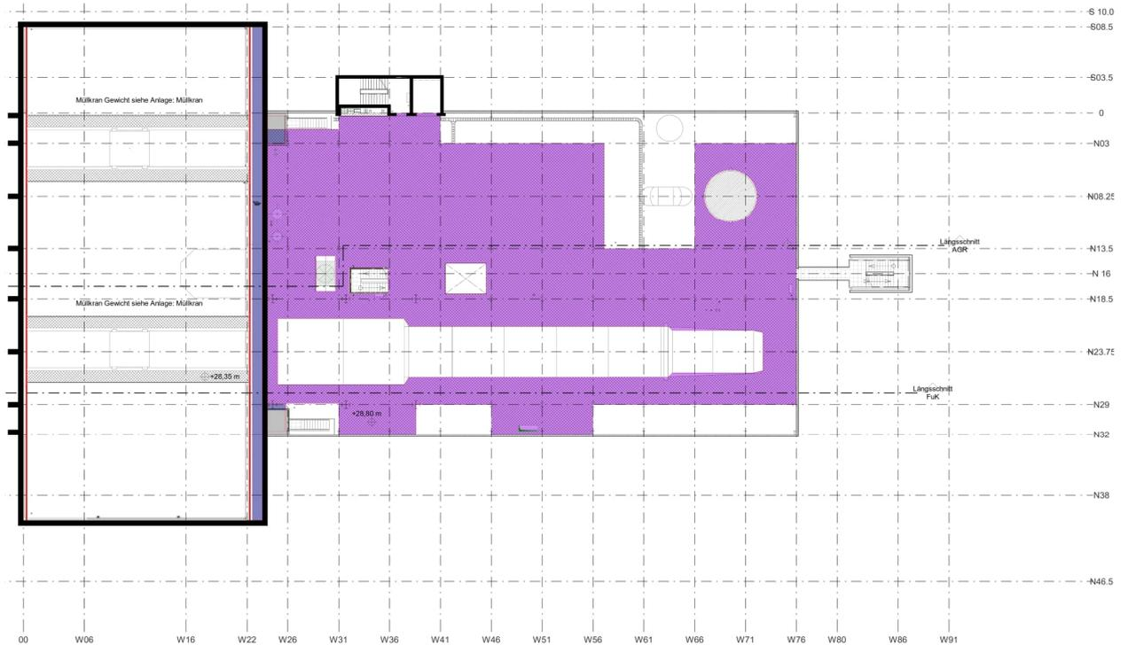
Abbildung 7: Nutzlasten Grundriss +28.60m
