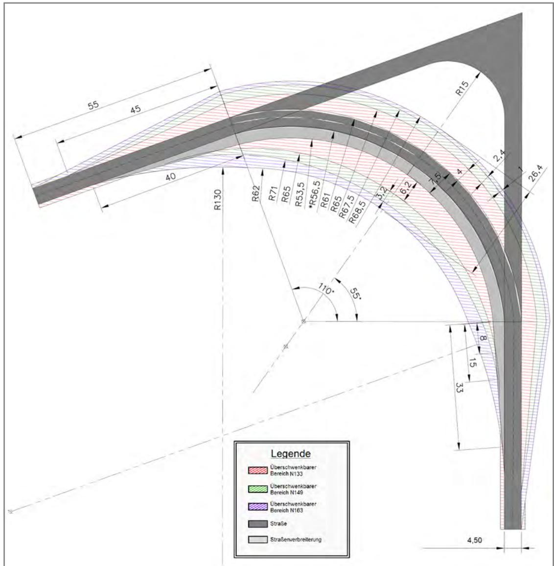
Abb. 13: Minimaler Ausbau 70°-Kurve allgemein, Darstellung ohne Einsatz einer zusätlichen Schlepphilfe
