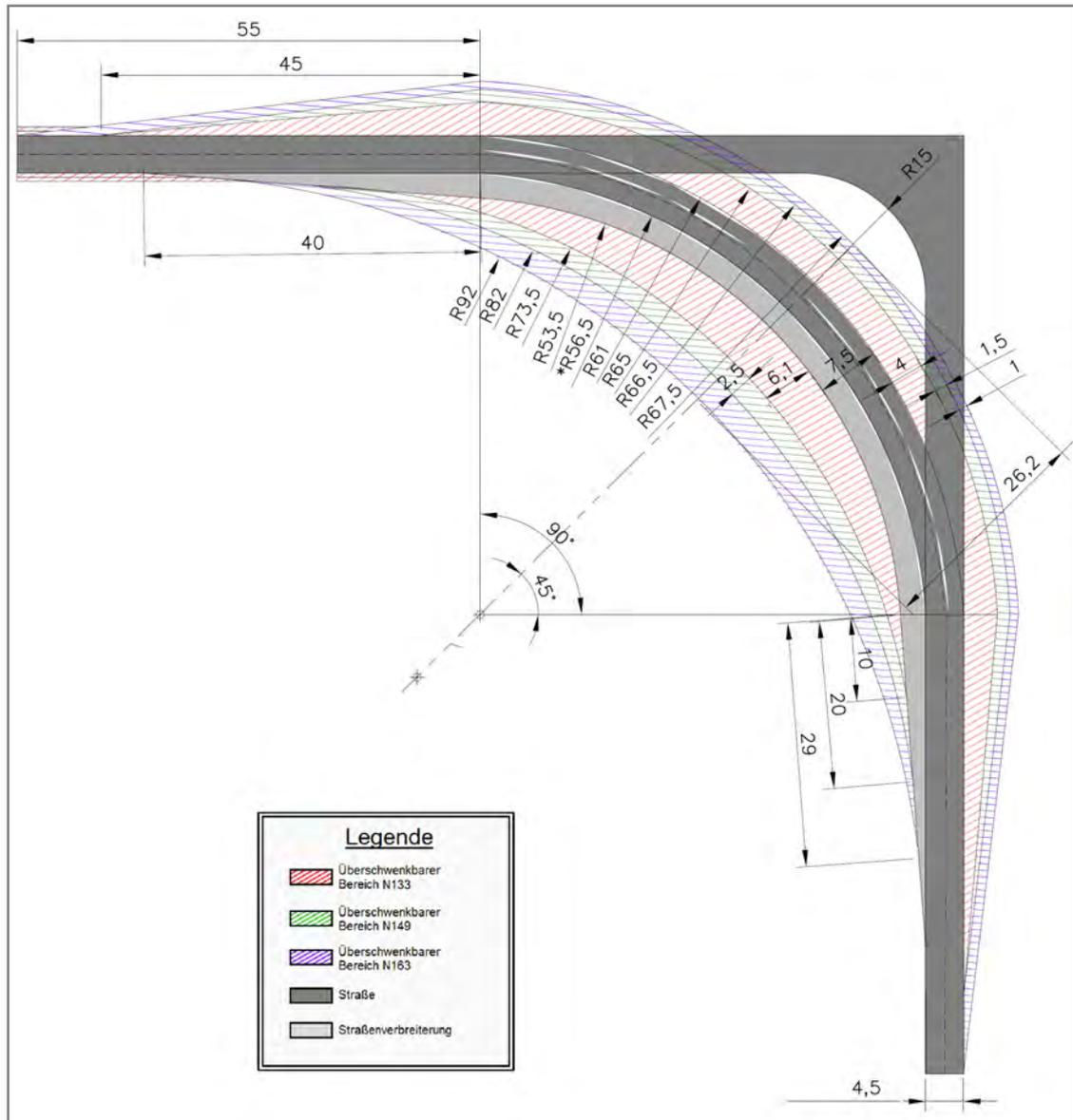
Abb. 14: Minimaler Ausbau 90°-Kurve allgemein, Darstellung ohne Einsatz einer zusätzlischen Schlepphilfe
