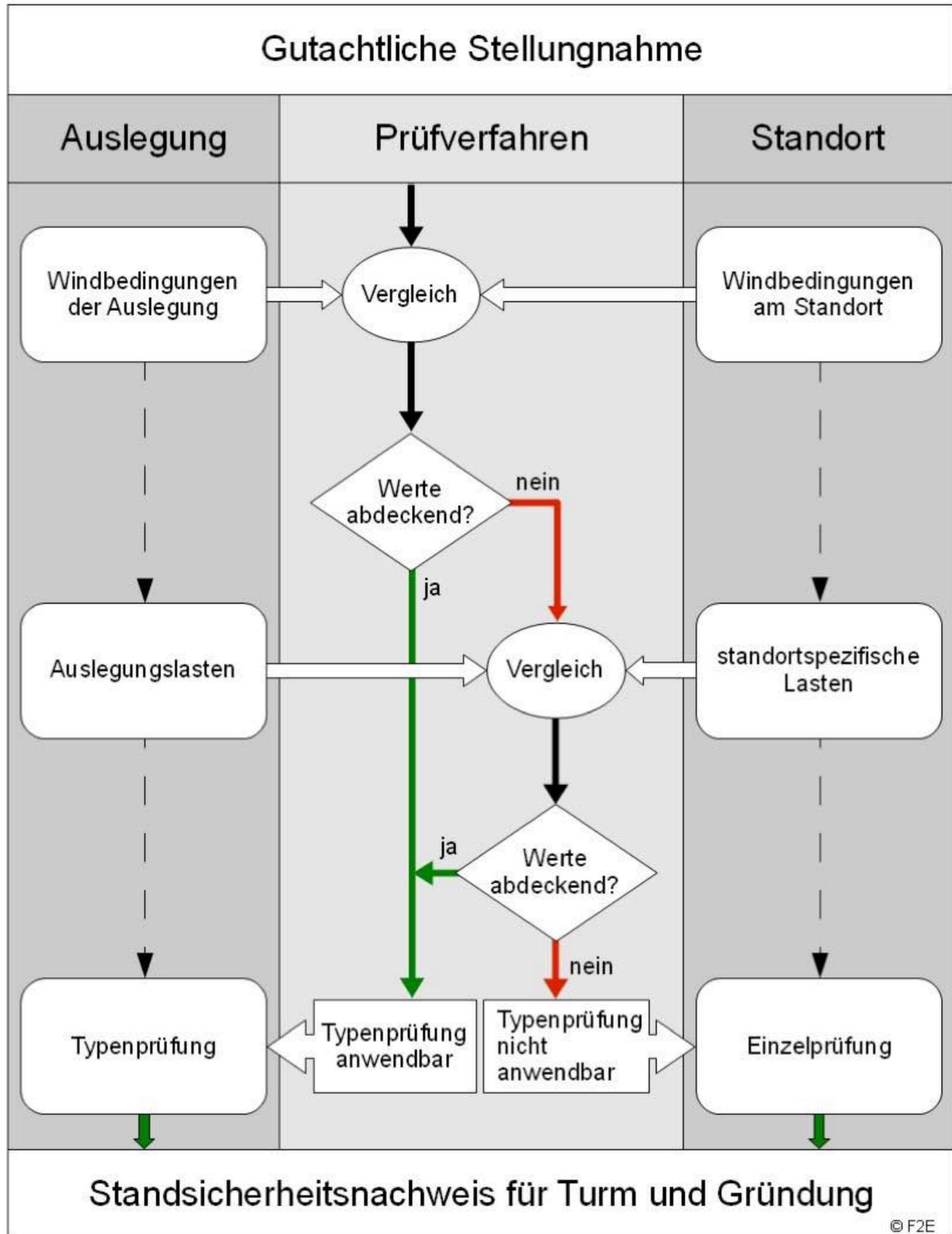
Abbildung 2.1.1: Schematische Darstellung des Prüfverfahrens.
