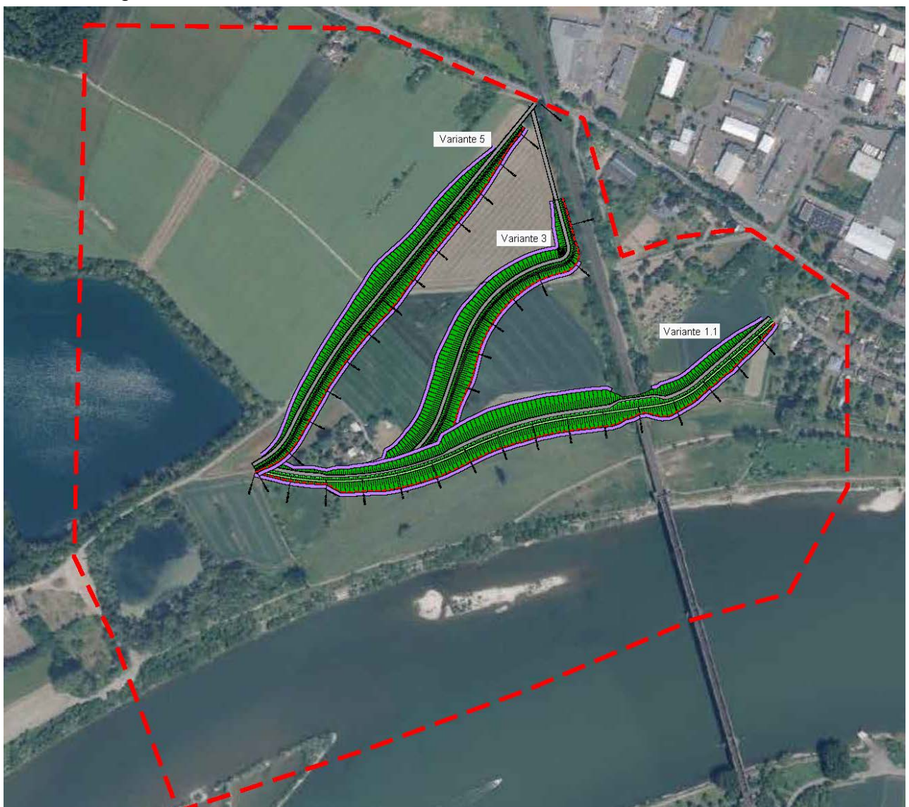
Abb. 12: Verlauf der drei Deichvarianten und Grenzverlauf des Untersuchungsgebiets (rot gestrichelt) nach vorliegenden Planunterlagen.
