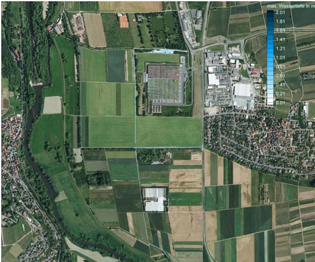
Abbildung 54: Wassertiefen und Überschwemmungsflächen beim 100-jährlichen Binnenhochwasser, Einstau der Hochwasserrückhaltung Sponsheim infolge eines 100-jährlichen Nahehochwassers und mittlerer Untergrunddurchlässigkeiten
