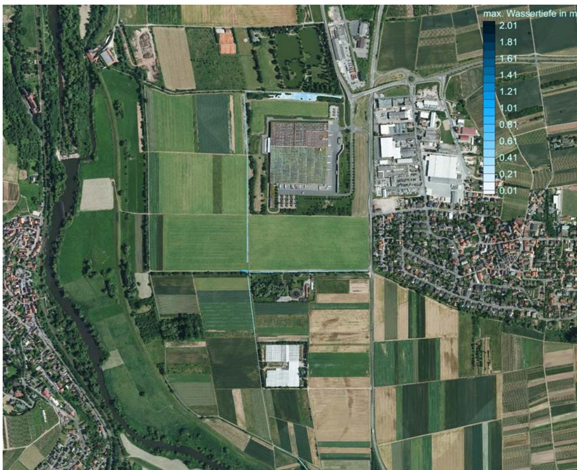
Abbildung 58: *Wassertiefen und Überschwemmungsflächen beim 100-jährlichen Binnenhochwasser, Einstau der Hochwasserrückhaltung Sponsheim infolge eines Nahehochwassers wie 1993 und mittlerer Untergrunddurchlässigkeiten*
