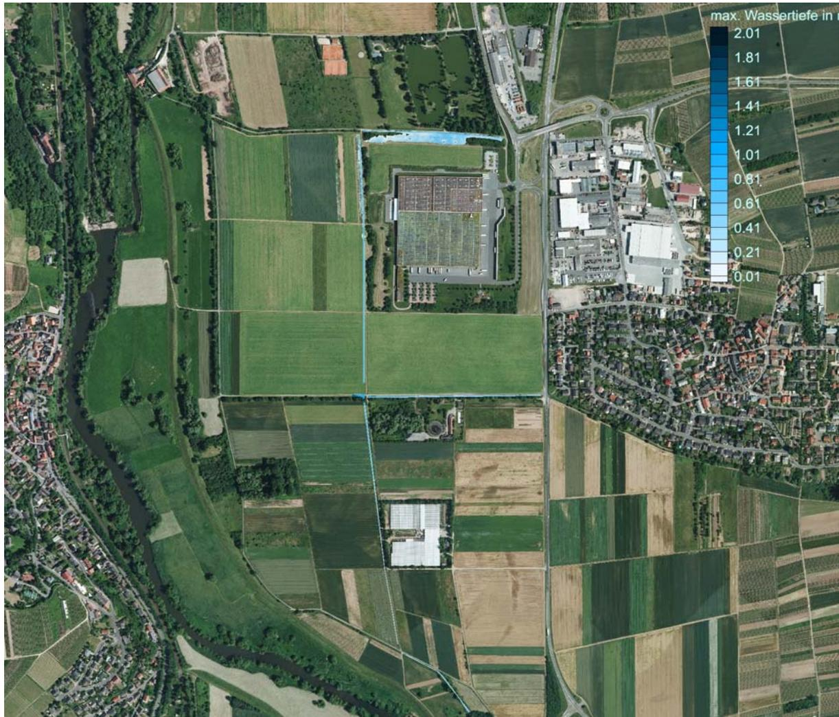
Abbildung 62: *Wassertiefen und Überschwemmungsflächen beim 100-jährlichen Binnenhochwasser, Einstau der Hochwasserrückhaltung Sponsheim infolge eines Nahehochwassers wie 1993 und erhöhter Untergunddurchlässigkeiten*
