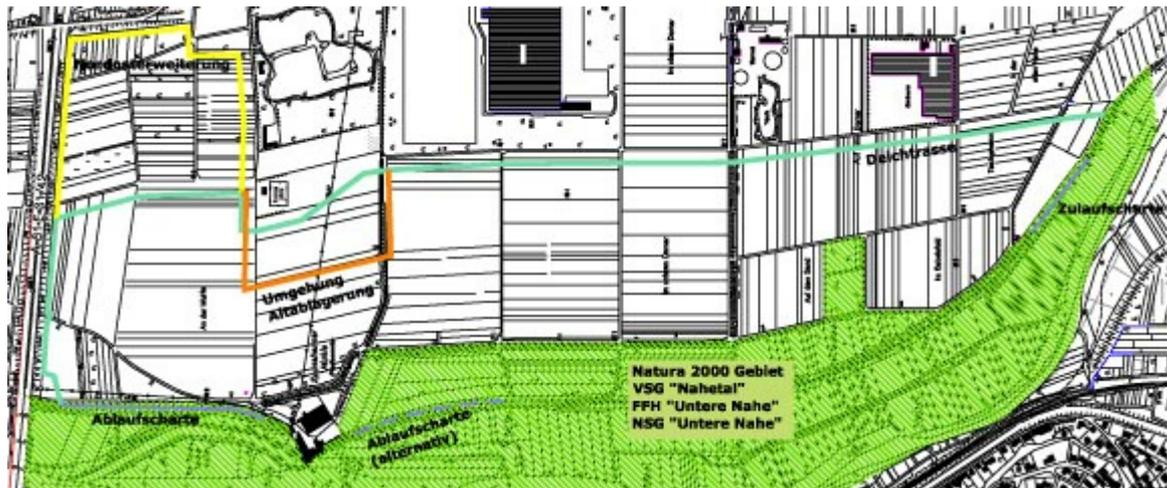
Abb. Nr. 2: Trassenverlauf mit Nordosterweiterung (gelbe Linie) und Umgehung Altablagerung (orange Linie)
