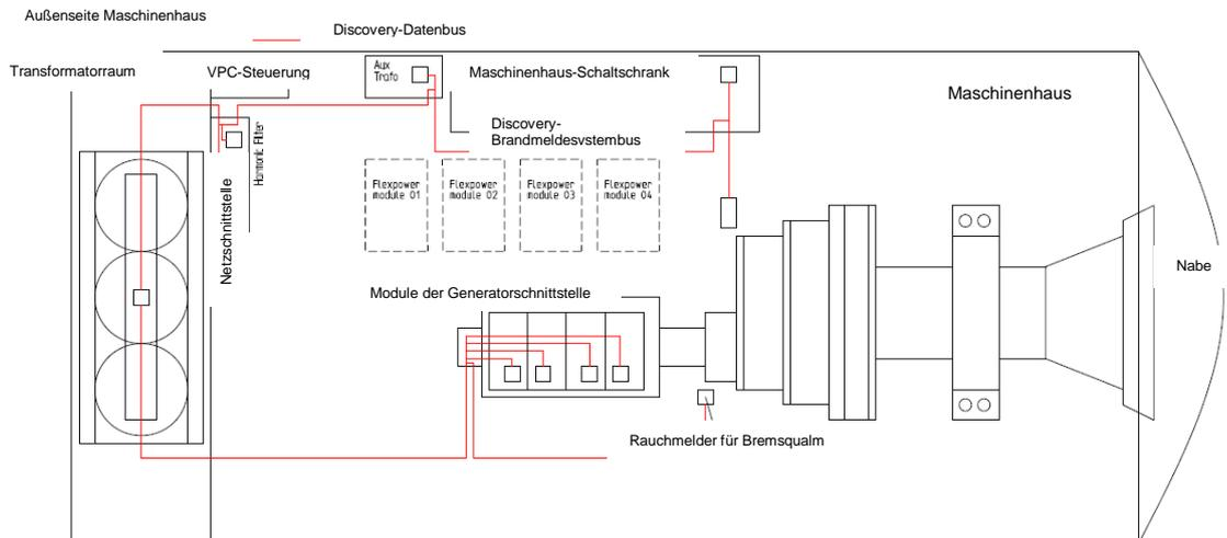
Abbildung 7-2: Beispiel für Systemaufbau in V112-3.0 MW
