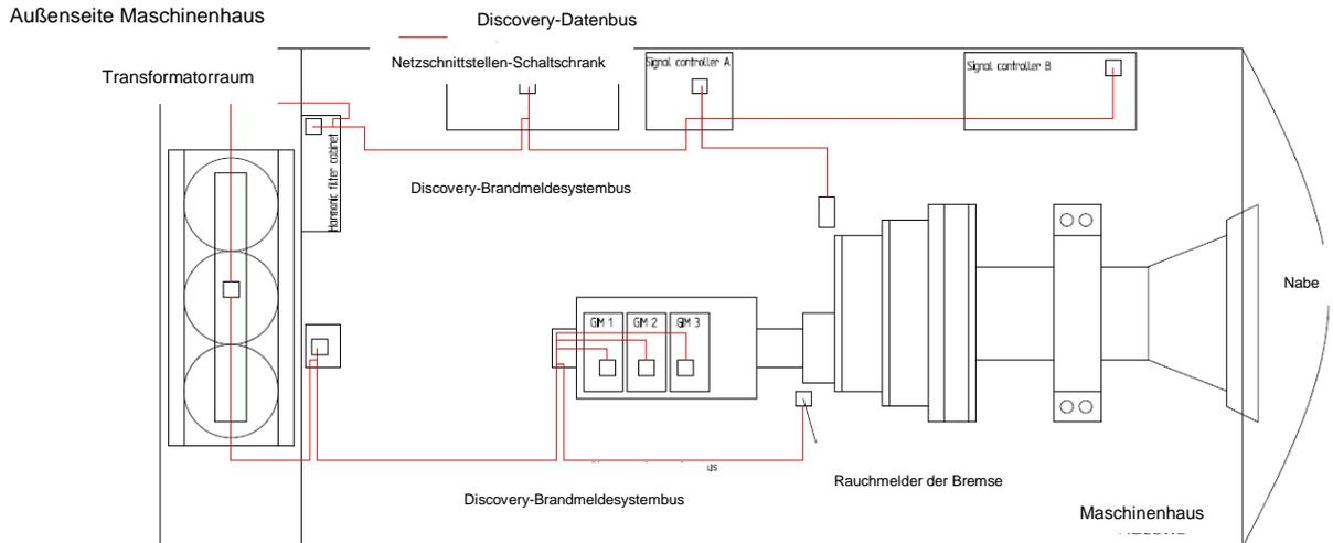
Abbildung 7-1: Beispiel für Systemaufbau in 2.0 MW, Mk 8
