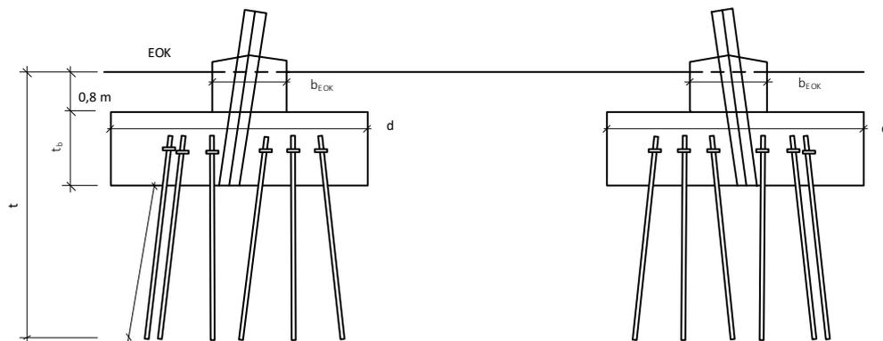
Fundamenttabelle Mikropfahlfundament mit Block Mast Nr. 1011
