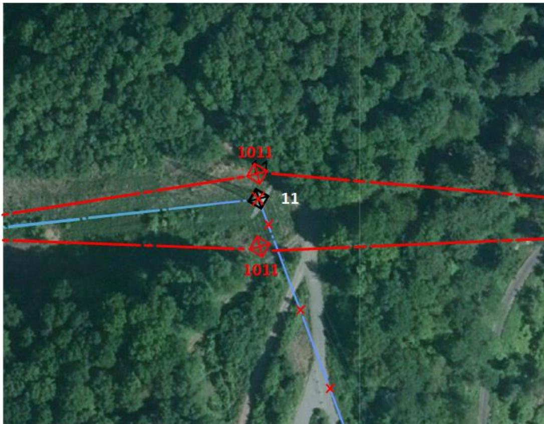
Abbildung 2: Verschiebung außerhalb der Leitungsachse, Neubau Mast Nr. 1011 nördlich oder südlich des Bestandsmasten
