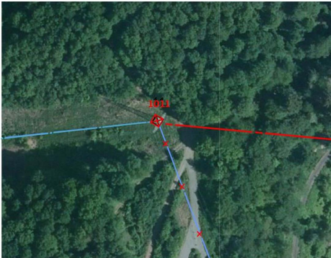
Abbildung 1: Verschiebung in Leitungsachse, Neubau Mast Nr. 1011 Punkt-auf-Punkt
