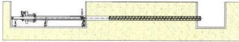
Abbildung 23: Schematische Darstellung Bohrpressverfahren (Quelle Creos)
