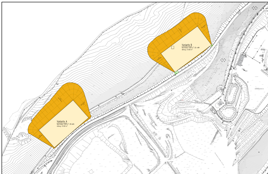
Abbildung 2: Standortvarianten A und B mit Abtragsmengen
