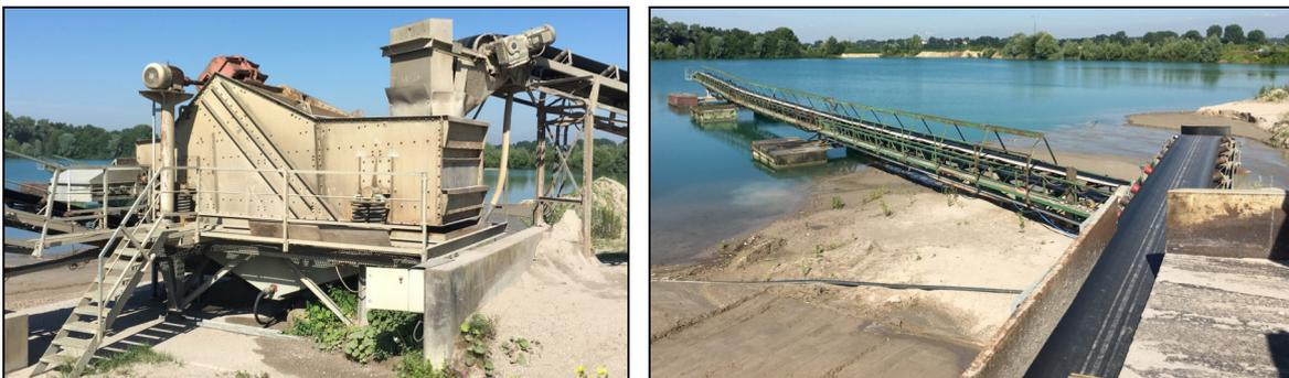
Abb. 6: Vorsiebmaschine (linkes Bild) mit Überkornband 1 und 2 (rechtes Bild) (Quelle: PFADT GMBH).
