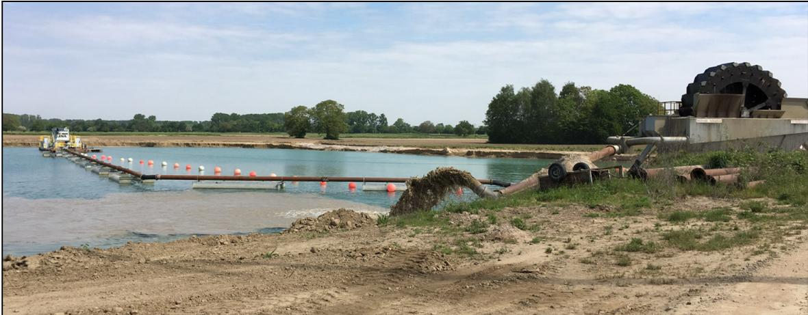
Abb. 5: Schwimmende Rohrleitung mit Schöpfrad (Quelle: PFADT GMBH).
