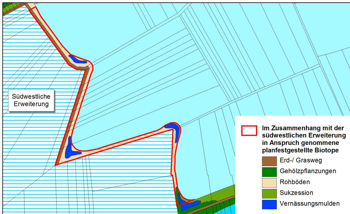
Abb. 49: Durch die südwestliche Erweiterung in Anspruch genommene planfestgestellte Rekultivierungsflächen (Quelle: Anlage A3 des zugelassenen Hauptbetriebsplanes)
