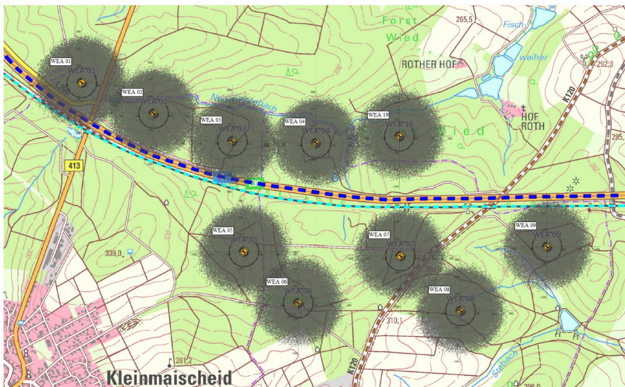
Abbildung 4: Auftreffpunkte bei Rotorblattbruch. Rotorblattradius schwarz gestrichelt.
