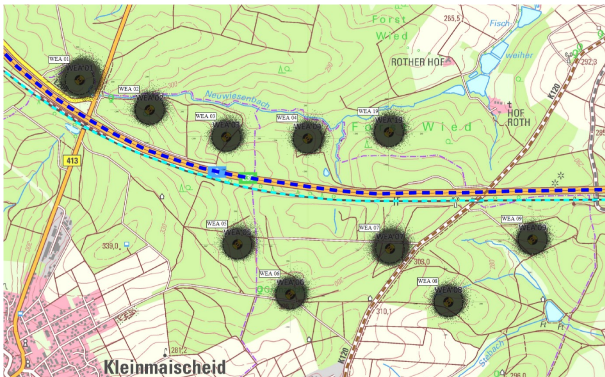
Abbildung 2: Auftreffpunkte bei Eisabfall. Rotorblattradius schwarz gestrichelt.
