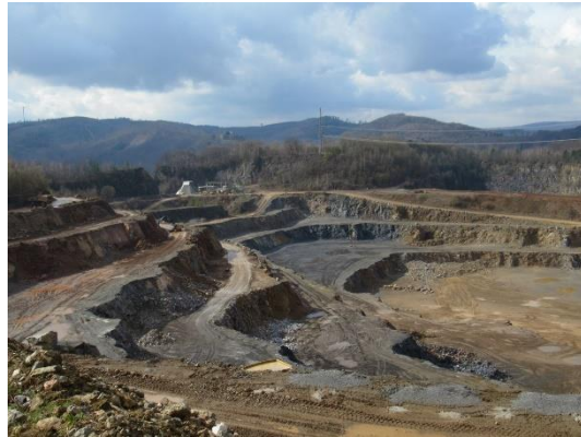
Abb. 4 Arbeitssohlen des Kalksteinbruchs.
