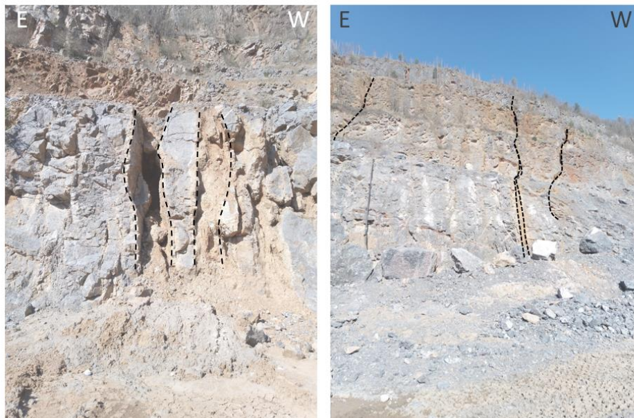
Abbildung 9: Nordböschung, links: gestrichelte Linien markieren Kluftöffnung, rechts: gestrichelte Linie markieren Klüfte, die sich über die ganze Nordwand erstrecken.
