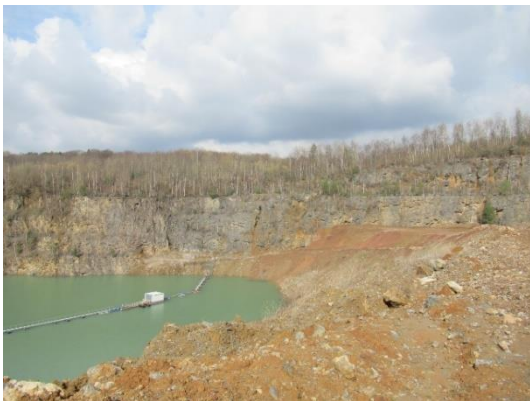
Abb. 8 Klärteich im östlichen Kalksteinbruch.
