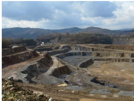
Abb. 7 Abbausohlen im Kalksteinbruch.
