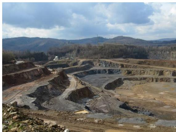
Abbildung 7-7 Abbausohlen im Kalksteinbruch.
