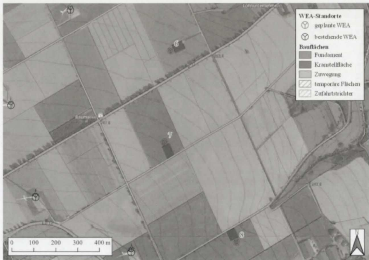
Abbildung 3: Darstellung der Baustellenflächen der geplanten V-126
