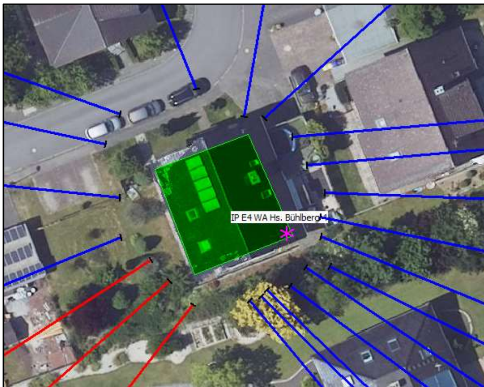
Ausschnitt NRW Luftbild DOP / Lage IP E4 WA Hs. mit Schallstrahlen & lautestem Punkt
