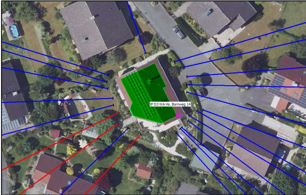
Ausschnitt NRW Luftbild DOP / Lage IP D3 WA Hs. mit Schallstrahlen & lautestem Punkt
