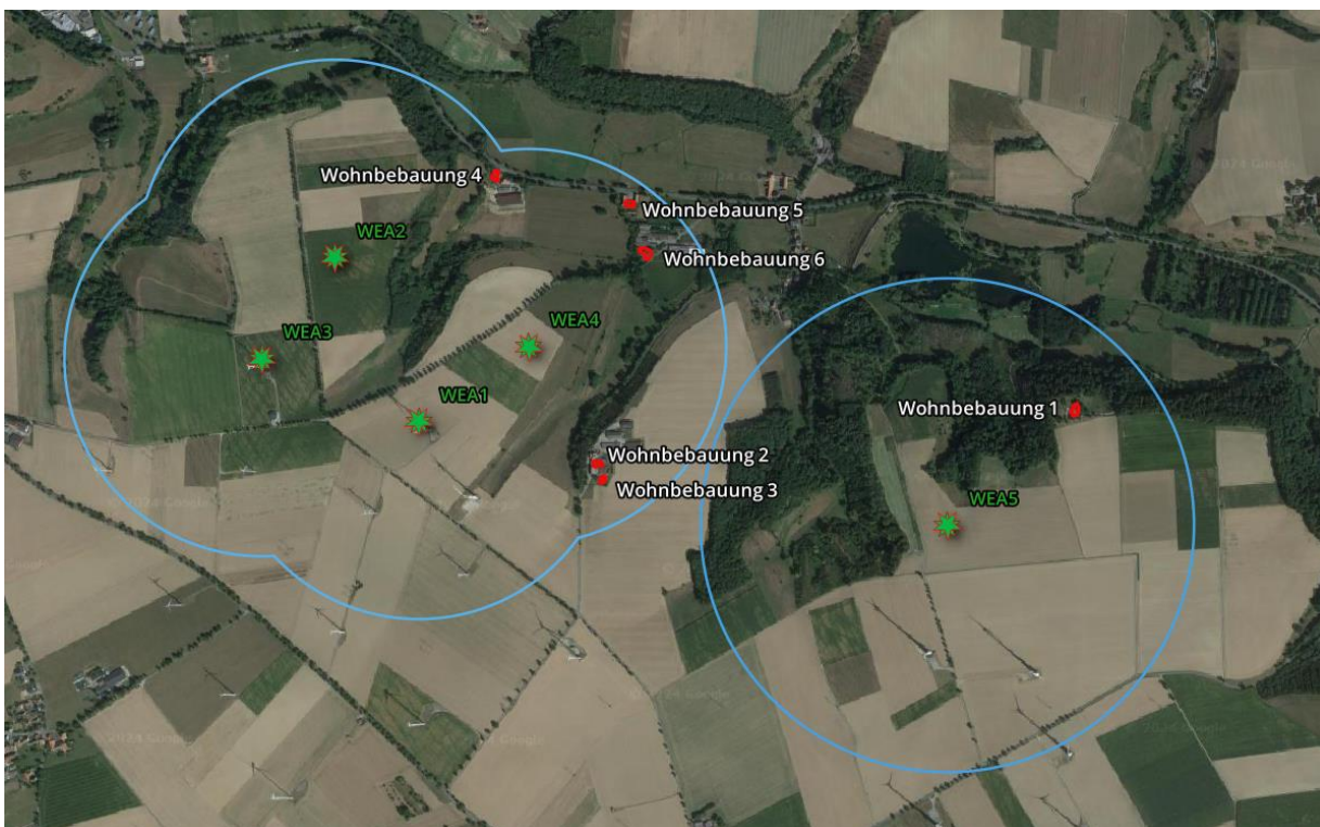
Abbildung 5: geplante WEA mit Radius (blaue Linie) jeweils 3-fache Gesamtanlagenhöhe und nahegelegene Wohnbebauungen (rote Markierungen); Quelle: Google Satellite (durch Verfasser ergänzt)
