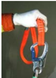
Abb. 9: Lange Bandschlinge im Endkarabiner des Rettungsseils
