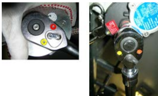
Abb. 11: Hebelstellung Rot am Abseil-Rettungsgerät und an der Knarre
