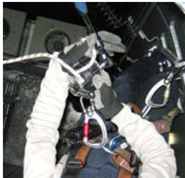
Abb. 32: Rettungsgerät in die Brustöse eingehängt
