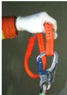
Abb. 39: Lange Bandschlinge am Endkarabiner des Rettungsseils
