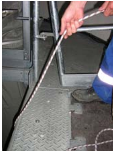
Abb. 12: Ablassen des Rettungsseils
