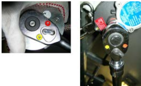
Abb. 27: Hebelstellung Rot am Rettungsgerät und an der Knarre
