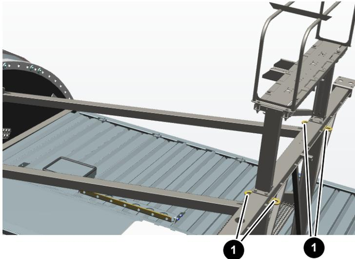
Abb. 8: Anschlagpunkte zur Personensicherung auf dem Dachmodul
