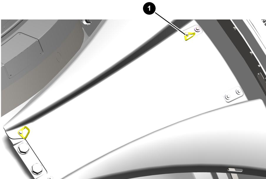
**Abb. 15: Anschlagpunkte zur Personensicherung an der Rotorkopfverkleidung**
