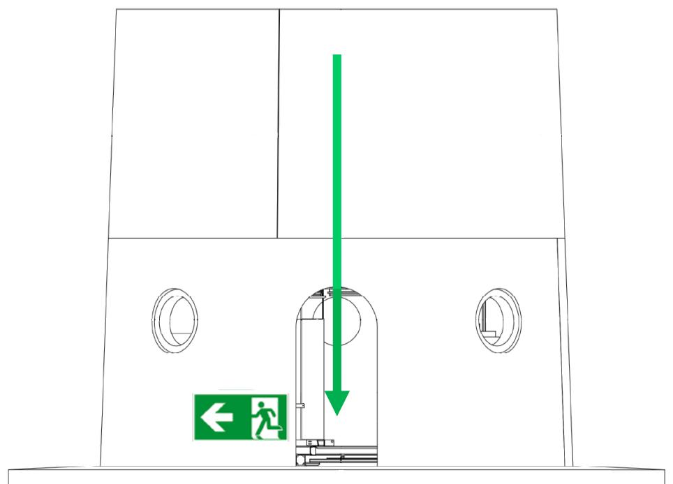
Exemplarische Darstellung der Rettungswege im Maschinenhaus und Turmfuß, Rettungsplan wird beim Bau der WEA objektbezogen angepasst. Feuerlöscher im Maschinenhaus und Turmfuß vorhanden.
