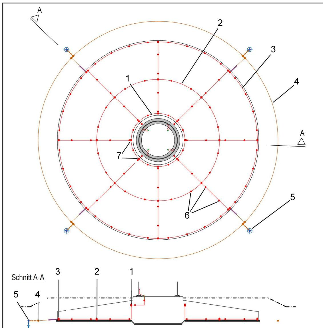
Abb. 1: Übersicht Blitzerkennung Turmfuß (Draufsicht Stahlrohrturm)
