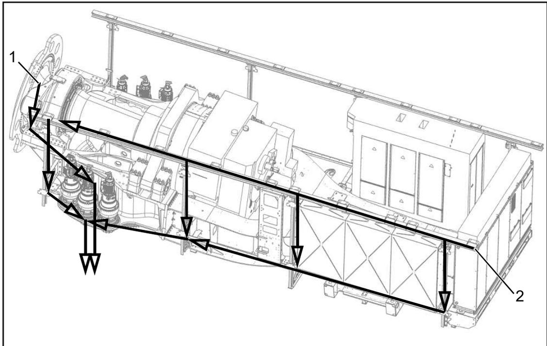
Abb. 3: Schematische Darstellung Blitzstrompfade (einseitig) im Maschinenhaus Delta 4000
