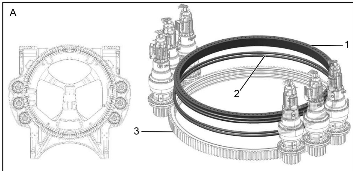
Abb. 4: Azimutlagerbereich mit Blitzstromableitung; Ansicht von unten (A)
