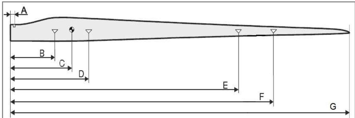
Abb. 5: Transportabmessungen Rotorblatt Seitenansicht
