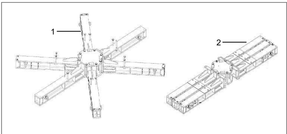
Abb. 9: Transportvorrichtung Nabe aufgebaut (1) und demontiert (2)
