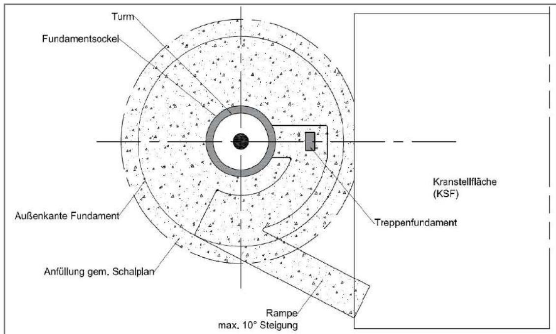
Abb. 28: Fläche um den Turm in Draufsicht, Hybridturm
