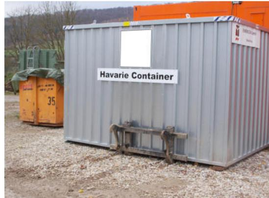
**Abbildung 2:** Mobiler Havarie Container - Beinhaltet Materialien zur Bekämpfung ausgetretener, wassergefährdender Stoffe
