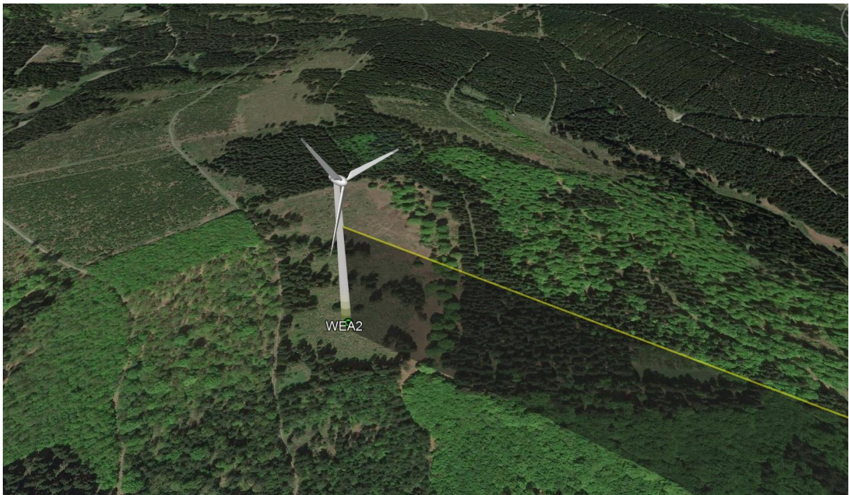
Abbildung 8: Schematische, maßstäbliche Darstellung des Höhenbezuges gegenüber der Radarantenne für die örtliche Topografie für 0,2° Elevation
