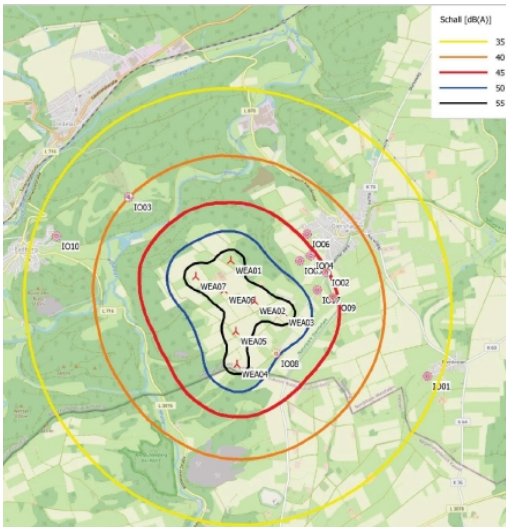
Abbildung 12: Darstellung der Schallausbreitungskarte der Zusatzbelastung Tag mit den Isophone 35 bis 55 dB(A) tags
